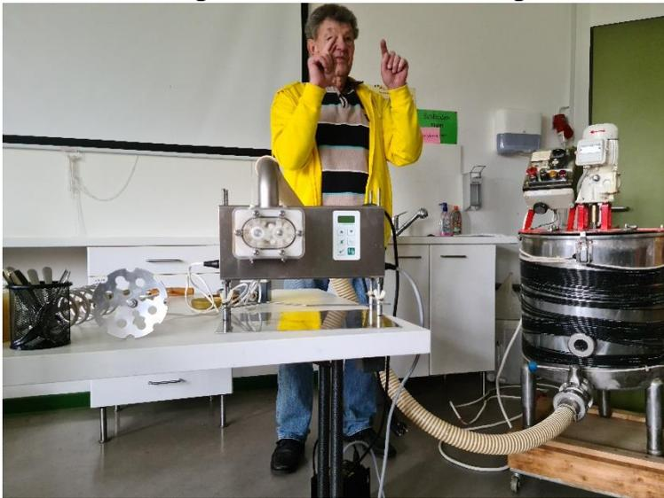
Der Honig wird eingefüllt, angewärmt und über eine Automatik 7 min gerührt, 10 h in Ruhe belassen. Bei Rapshonig ändert die Frequenz sich auf 7 min rühren und 2 h Pause. Dieser Turnus wird so oft durchlaufen, bis der Honig Schlieren bildet und beim Rühren eine leichte Welle schlägt. Wie lange, das hängt von der Art des Honigs und vor Allem vom Rapsanteil ab. Durch sein geschlossenes System zum Nassenheider Fillup (3000,-€)
